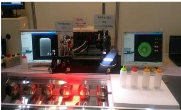
画像処理器(PV200)を制御・搬送まで含めたシステムとして樹脂ボトルの欠点検査・キャップの色判別をテーマに展示
